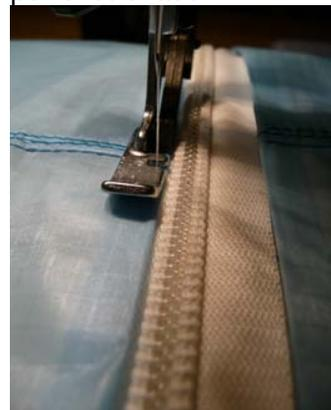
No termine la costura a máquina hasta que todas las partes del perfil de la parte inferior de la cola estén montadas e hilvanadas. Entonces cerrar con una costura alrededor.
